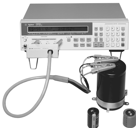
図1 16089A テストフィクスチャを用いた 大容量コンデンサ測定
