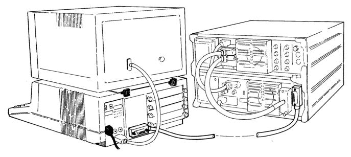
FIGURE 1. SYSTEM CONNECTION
