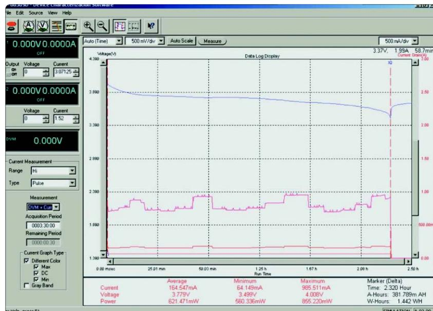
图3. 14565A Data Log 模式，显示电池耗尽测试
