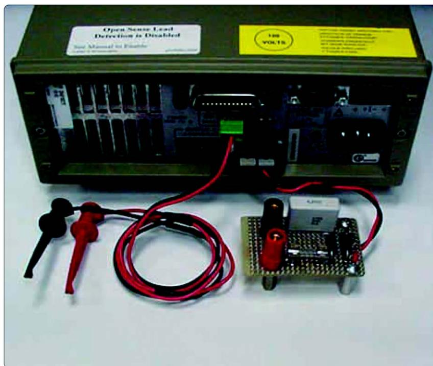
图 2. 外部保护网络和 DVM 引线实例。
