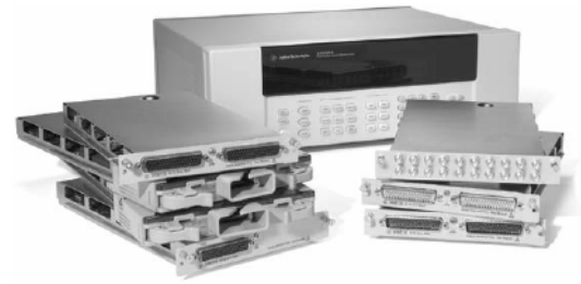
圖 3 典型儀器（如 Agilent 34980A 多函數切換/量測裝置）可以增強與 LXI 類別 C 相容。
