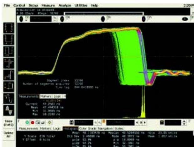
图 5. 使用 Agilent MSO8104A 进行的 32000 个波形分段采集，并带有测量统计数据 and 抖动直方图
