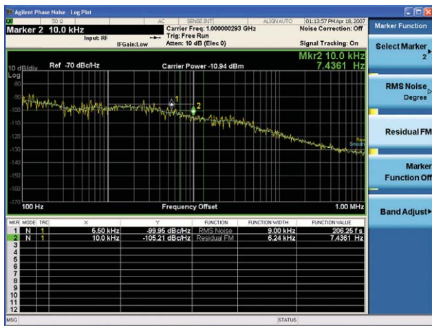
図3. バンド・マーカを使用した、位相雑音ジッタの実効値の計算
