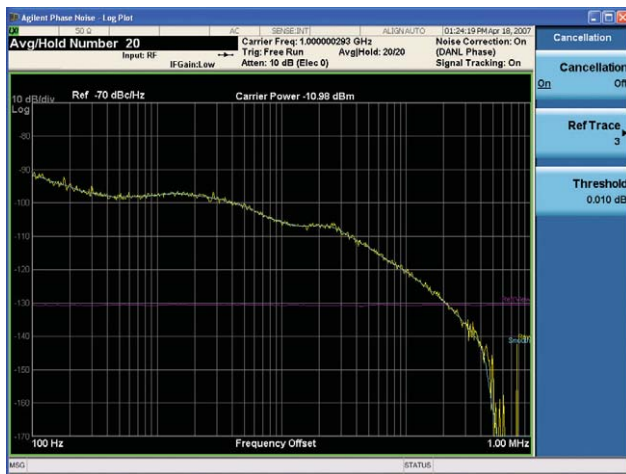
図7. DANLフロア・ノイズの減算を行った場合の位相雑音プロット。DANLトレースはマゼンダで表示されています。
