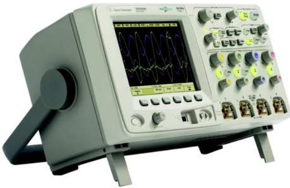
您只需几分钟，便可以了解新一代便携式示波器——Agilent 5000 系列。新型 5000 系列配备 1 Mpts 存储器和高分辨率 XGA 显示器(具有 256 级亮度、100000 个波形/秒的快速更新速率)，可为您提供便携式示波器前所未有的功能。
