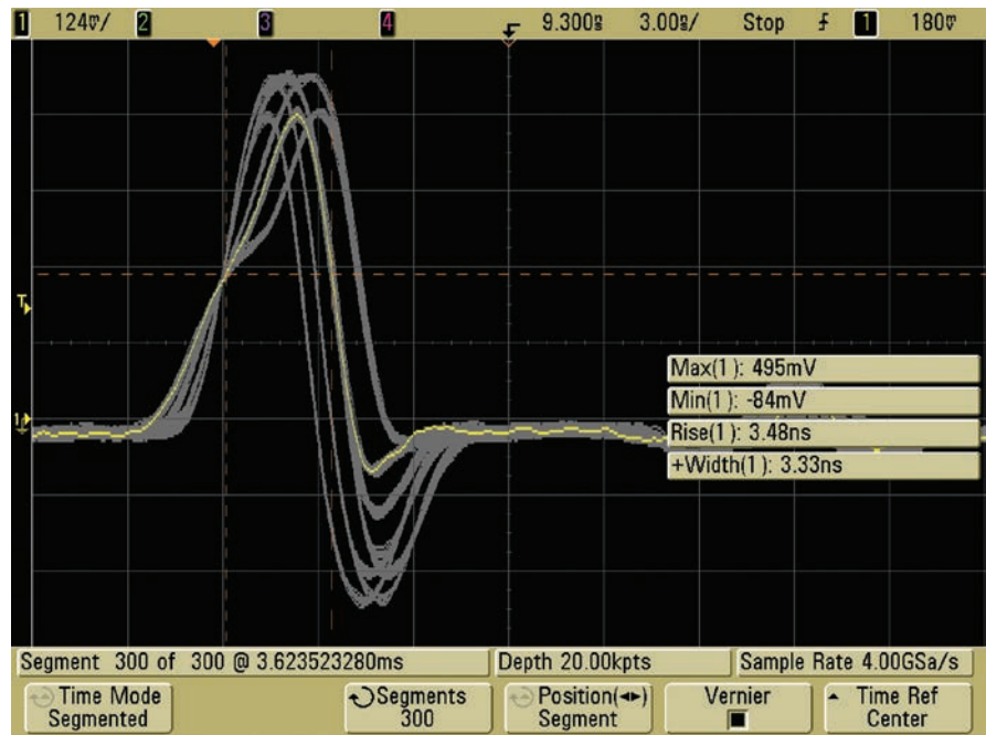
圖 1：分段式記憶體擷取模式可擷取 300 個連續的雷射脈衝以進行分析。
