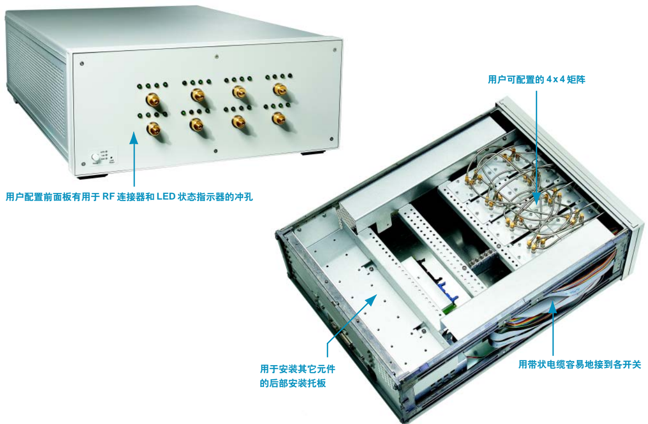
图 3. 用户可配置的 L4491A RF 开关平台
