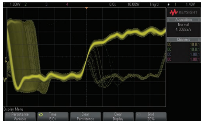
圖 3：當更新率為每秒 1,000,000 個波形，Keysight MSO/DSO3000 X 系列示波器能夠可靠地擷取偶發亞穩態。
