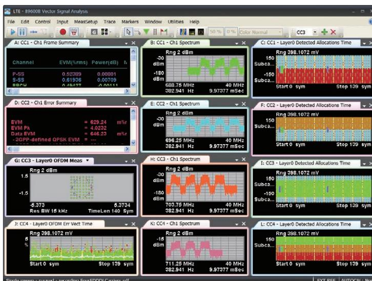
最大5個のCCを同時に評価可能。測定パラメータを設定して、各CCのさまざまな測定が可能
