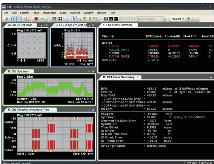
オプションBHGを使用して、LTE-Advanced FDDアップリンクのクラスタ化SC-FDMA信号を徹底的に評価可能
