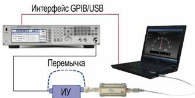
Рисунок 2 - Метод измерения с поствыравниванием по уровню является менее затратным при более высокой точности
