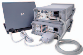
82357B GPIB-USBインターフェースによる接続例
