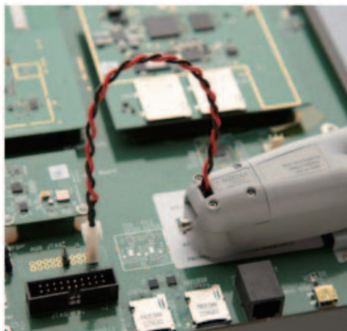
図4. 付属のメイク・ピフォア・ブレイク(MBB)コネクタを使用すれば、はんだ付けされたリード線の接続や取り外しを行うことなく、DUTのさまざまな場所を短時間でプロービングできます。
