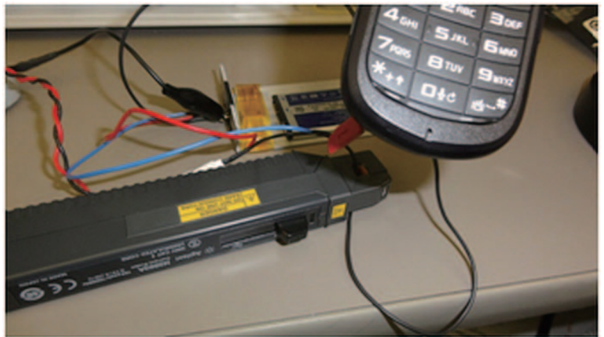
図2. キーサイトの1147BやN2893Aなどのクランプ型電流プローブを使用すれば、オシロスコープで簡単に電流を測定することができます。
