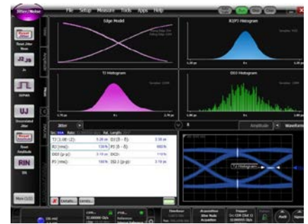
圖 4：32 Gb/s PRBS 2^{11}-1 顯示 138 fs 隨機抖動 (rms)
