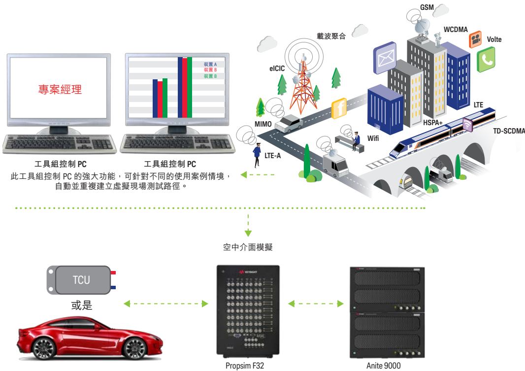
圖 3：虛擬路測工具套件讓您在實驗室中模擬真實世界的射頻網路狀況，以便利用現場擷取到的資料，建立可在虛擬環境中重建行車路徑的測試。
