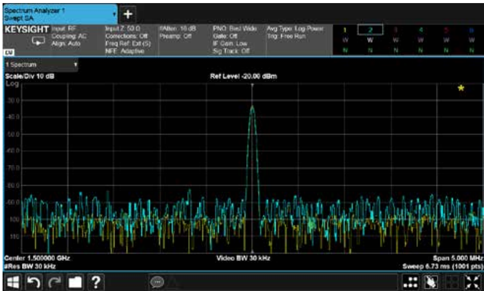
圖 17：第二諧波量測出現在相同的振幅，代表分析儀本身的失真未在結果中造成誤差。
