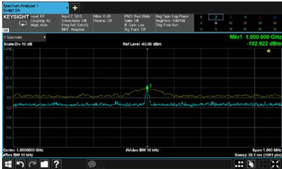
圖 4：將解析頻寬從 100 kHz 降到 10 kHz 可提升 DANL，並可更輕鬆地查看所需觀測的信號。
