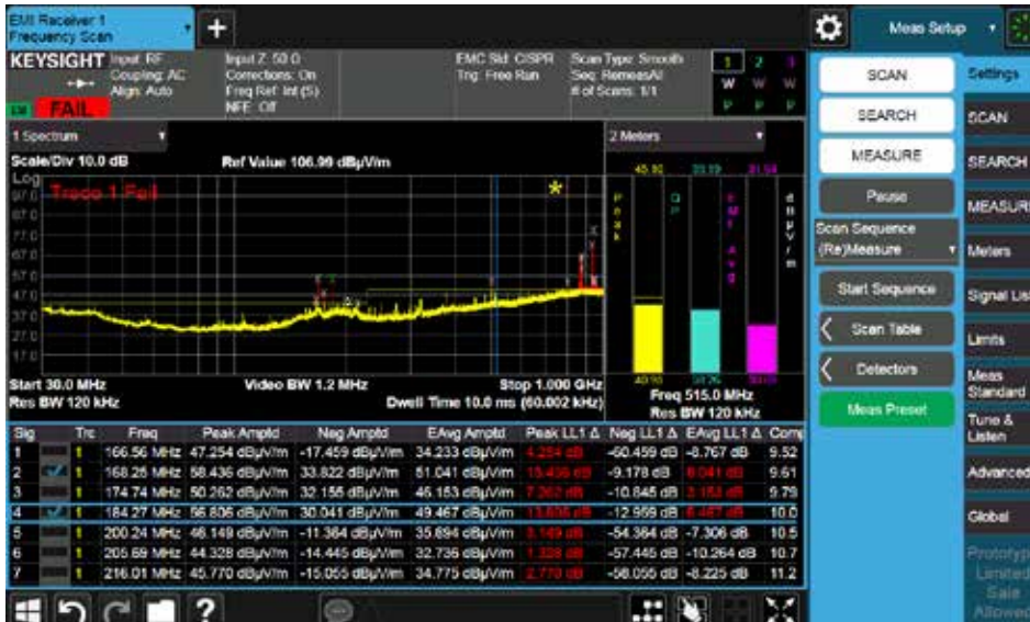
圖 13：執行傳導發射與輻射雜訊的先期認證量測時，Keysight N6141C EMC 應用軟體可依據 CISPR 16-1-1 或 MIL-STD 標準來配置量測。
