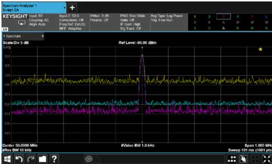
圖 8：在信號量測中，在縮減解析頻寬（黃色）、降低輸入衰減（藍色）並切換至功率平均（紫色）後，DANL 逐漸降低。
