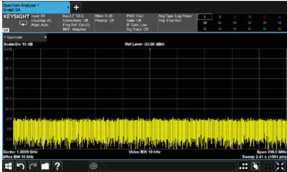
圖 5：以 10 kHz 解析頻寬進行量測所需的掃描時間為 2.41 s。
