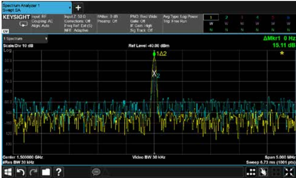
圖 16：因信號分析儀已將輸入衰減與參考位準納入考量，故視在第二諧波振幅的差異，是因分析儀的失真所導致。
