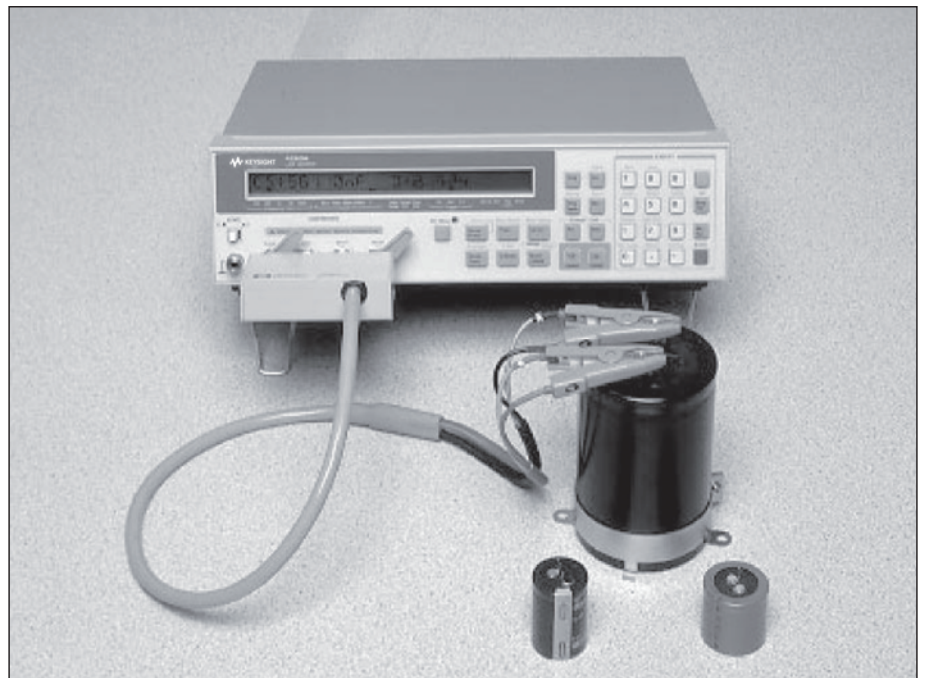
图 3. 使用 Keysight 16089A 的大规格电解电容器电极测量
