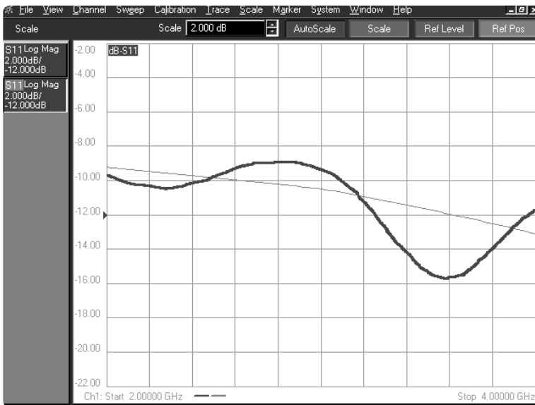
図20. 測定した表面実装増幅器のS11。大きなリップルのあるトレースは標準同軸校正を使用した場合の応答です。リニア・トレースはディエンベディングを行った場合の応答です。
