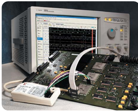
図1. FPGAダイナミック・プロービング機能により、FPGAのデバッグ効率飛躍的に改善されます。
