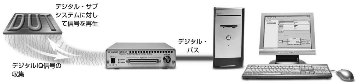
図2. N5110Bは、DUTに接続したN5102Aデジタル信号インタフェース・モジュール経由で、デジタルIQ/IF信号を直接収集／再生します。
