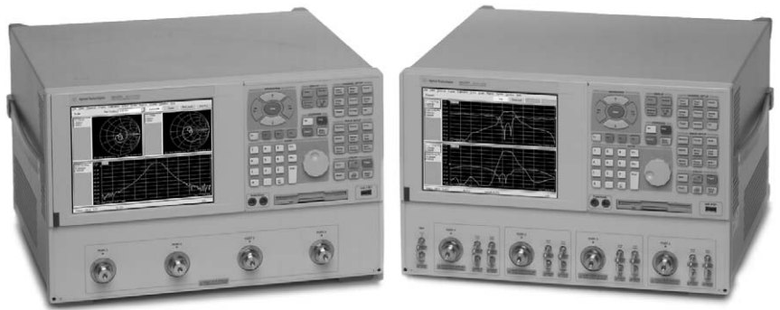
図1. N5230A。オプション240の標準テスト・セット(左)とオプション245の拡張可能テスト・セット(右)
