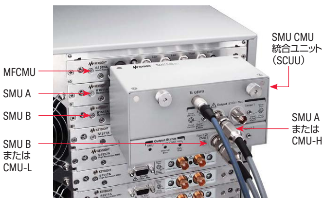
図3. SMU、MFCMU、SCUUを使った正確なIV/CV測定設定
