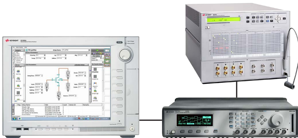
図6. B1500Aの内蔵PCでアナライザの測定リソースと外部GPIB測定器を制御する内蔵PC制御モード例
