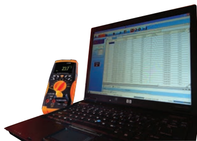
圖 1：利用隨附的 GUI 資料記錄軟體自動記錄量測過程與結果
