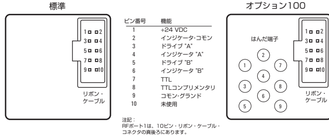
図8. ドライブ接続用ピン配置
