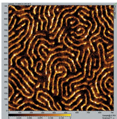
図2. MACモードによるブロック共重合体のトポグラフィック画像。スキャン・サイズ：900 nm × 900 nm
