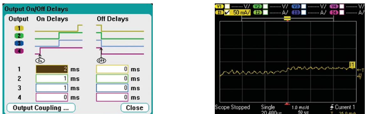
図 3. 出力シーケンス設定とターンオン時のコア電流
