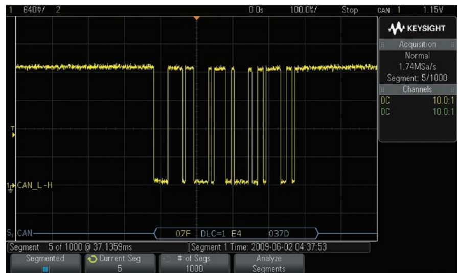
圖 4b：當區段 5 的時間標籤為 37.1359 ms，顯示的延遲為 4.816 ms 時所擷取的資料訊框 07F HEX 。
