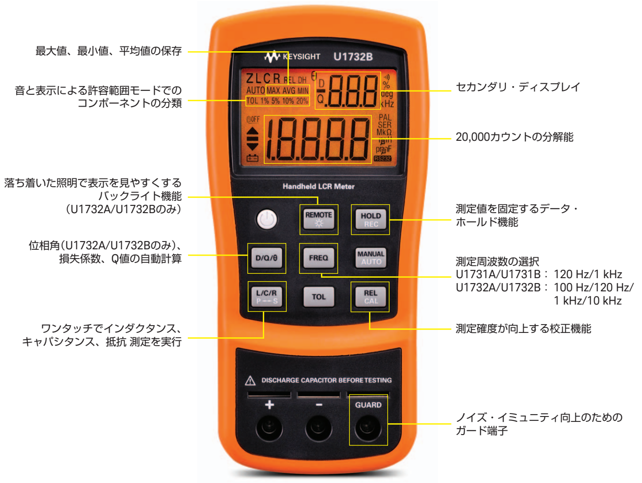
図2 : U1732Bのフロント・パネル
