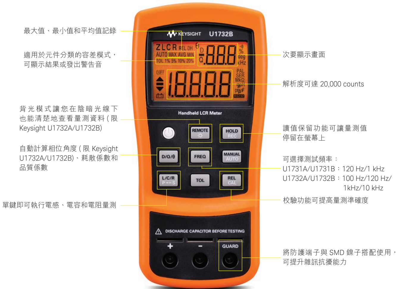
圖 2：Keysight U1732B 前面板
