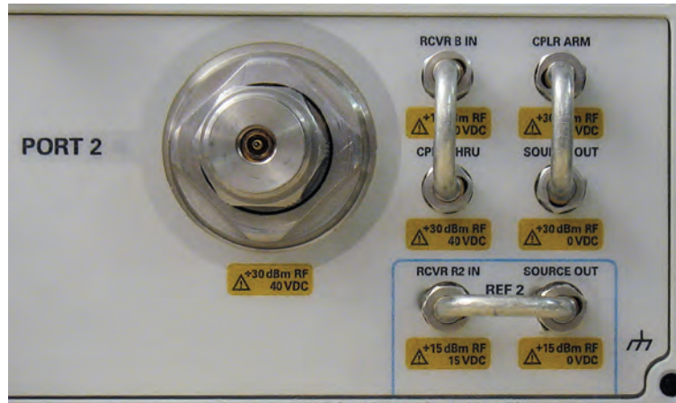
图 30. 把测试端口耦合器反接时的跳线连接方法(把耦合器的主臂和耦合臂对调)
