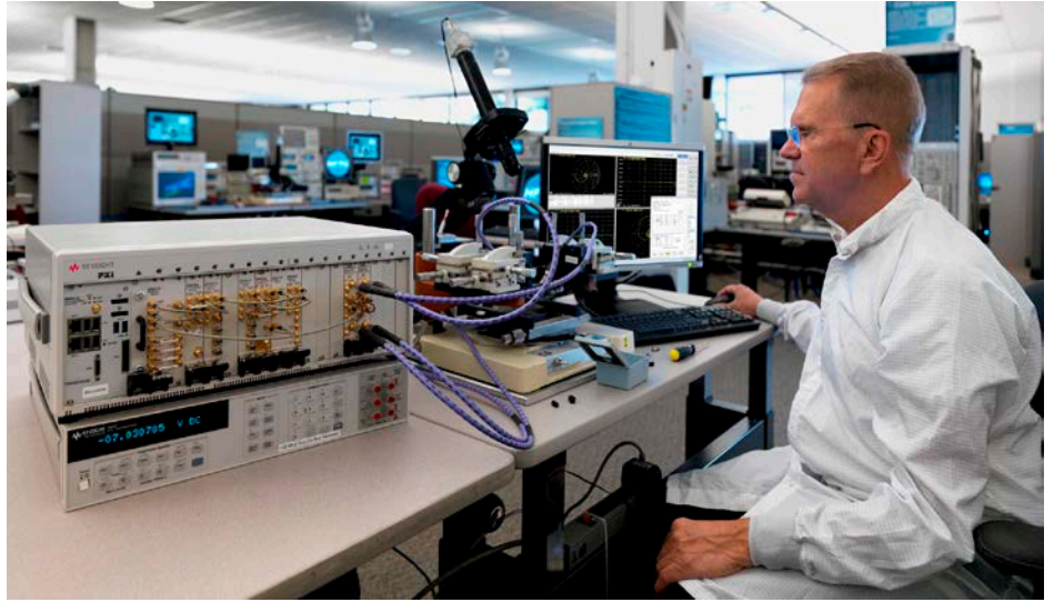
圖 1：使用 Keysight M937xA PXIe 向量網路分析儀、M9381A PXIe 向量信號產生器，以及 M9391A PXIe 向量信號分析儀，再搭配使用量測應用軟體，來測試功率放大器。
