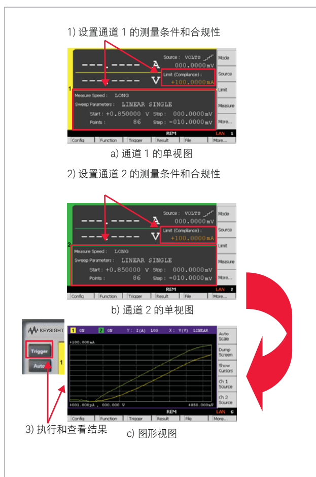
图 2. B2900A 系列 SMU 的图形用户界面有助于快速执行测量和显示测量结果
