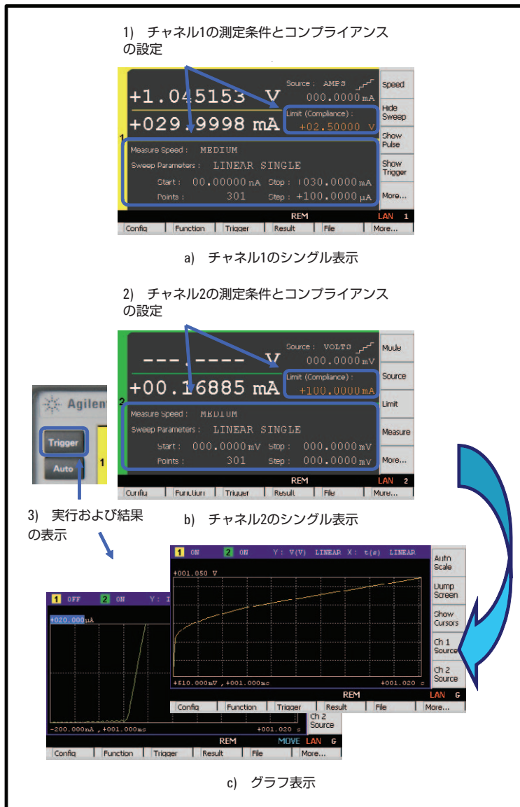
図2. B2900AシリーズのGUIからは、クイック測定や結果の表示が簡単にできます
