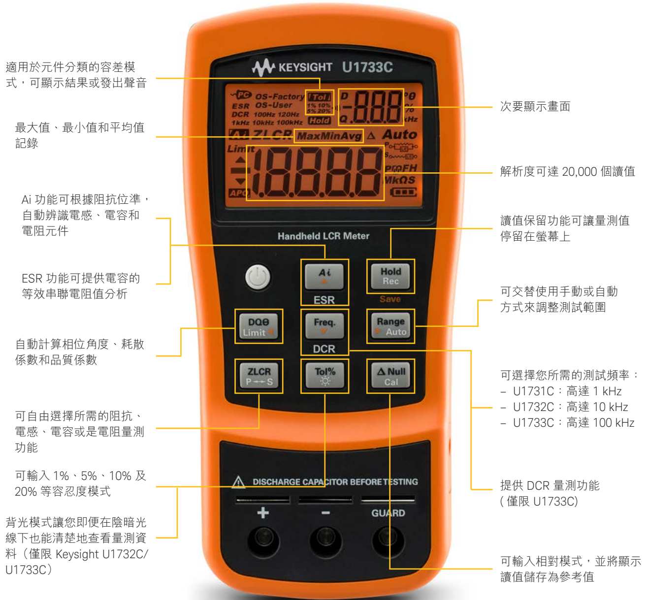
圖 2：Keysight U1733C 前面板
