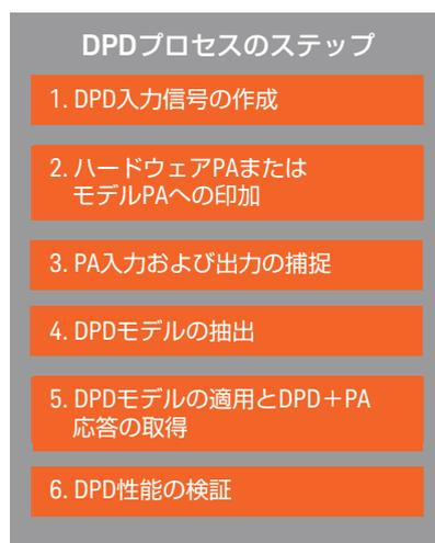
図3. 図2のセットアップを使用するDPDモデリング・フローは、6ステップのプロセスです
