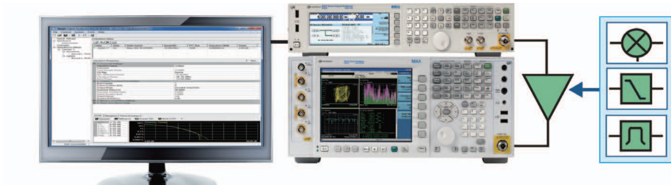
図1. Signal Studioのベーシック機能とKeysight Xシリーズ信号発生器およびXシリーズシグナル・アナライザを使用した、代表的なコンポーネント・テスト構成
