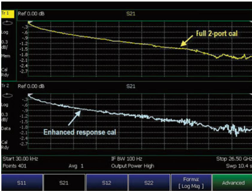
图3. 使用FieldFox CalReady双端口校准和CalReady增强响应校准对同轴电缆进行测量的结果比较。
