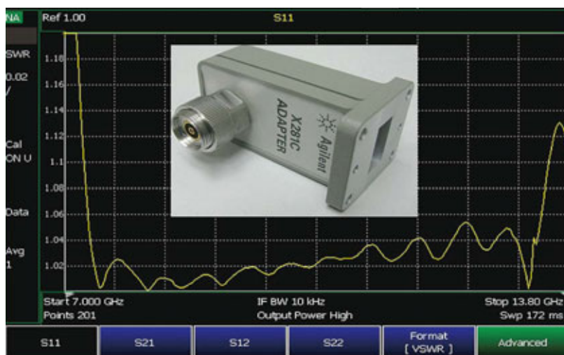
图 13. 使用未知直通技术对 X 频段同轴波导适配器的 VSWR 进行测量
