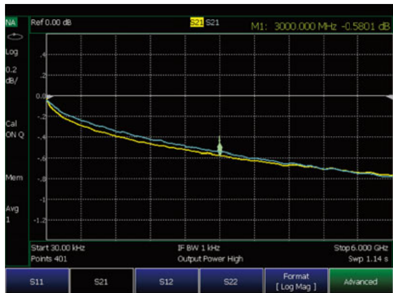
图 1. 使用 FieldFox 矢量网络分析仪提供的传统全双端口校准 (蓝色) 和快速 QuickCal (黄色) 对同轴电缆进行测量的结果。
