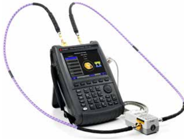
是德科技的高性價比電子校驗（ECal）模組使向量網路分析儀的校驗速度更快、操作更簡單且結果更精準。
