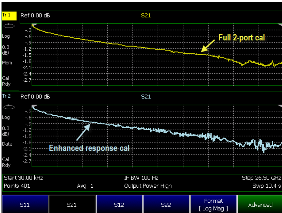
圖3：使用FieldFox CalReady 2埠校驗和CalReady增強響應校驗進行同軸電纜量測的比較
