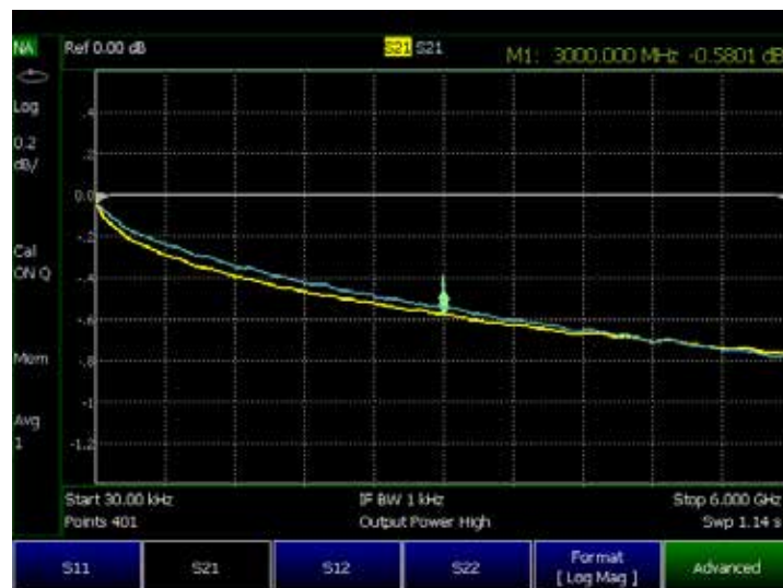
圖1：使用Keysight FieldFox向量網路分析儀提供的全2埠校驗（藍色）和快速QuickCal（黃色）來量測同軸電纜的結果比較
