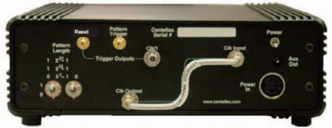
図2. N4974A PRBSジェネレータ 40 Gb/s(TG1P4A)の背面。パターン制御スイッチ、クロック入力/出力、トリガ出力があります
