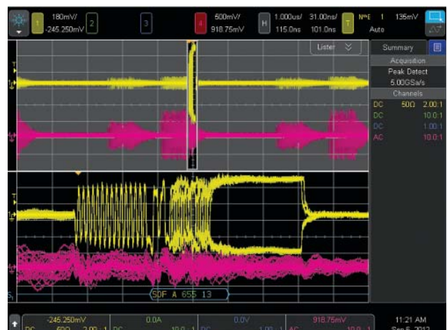
Figura 6: Péssimo layout da placa PC resultou em um ruído de comutação da fonte de alimentação, acoplado em um dos lados do barramento diferencial USB de alta velocidade.
