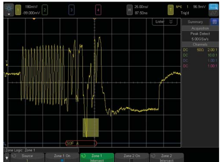
Figura 10: Disparo por região InfiniiScan pode ser utilizado para disparar apenas em problemas no sinal USB de alta velocidade.
