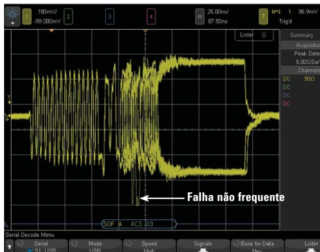
Figura 9: As rápidas taxas de atualização de forma de onda aumentam a probabilidade do osciloscópio capturar eventos aleatórios e não frequentes.
