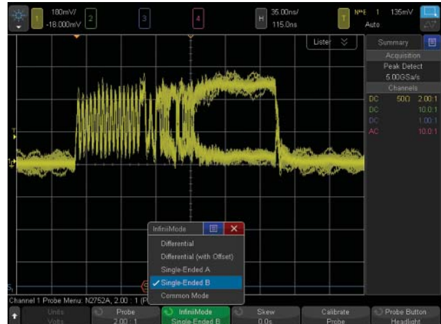
Figura 4: Capturando apenas o lado baixo (D-) do barramento diferencial.
