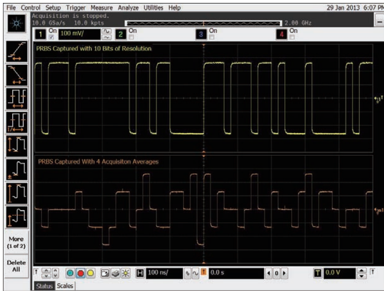
图 6. 高分辨率对于捕获低噪声 PRBS 信号效果极佳，但采集平均值不会。
