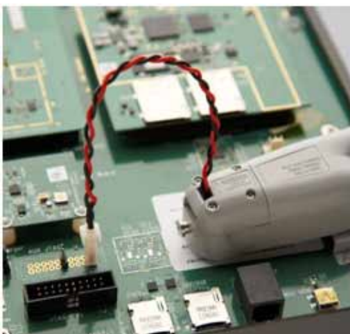
图 4 它附带的先通后断 (MBB) 连接器使您无需焊接或拆焊引线，即可快速地探测被测器件上的多个位置。
