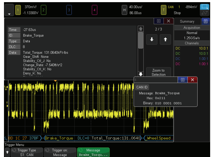
图 2a. 对 CAN 总线进行字符触发和解码
