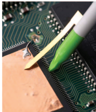
较小的探针、较短的接地连接可以减少噪声拾取和电感负载
