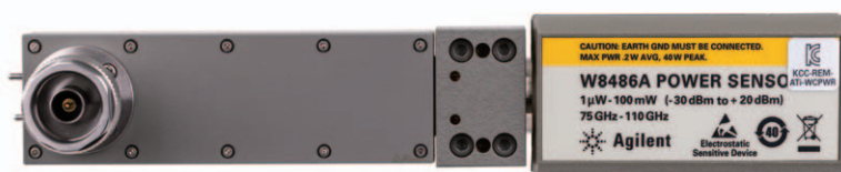
図4：W8486Aには、EEPROMが内蔵されていません。センサの背面に印刷されている校正係数をあらかじめパワー・メータに入力する必要があります。
