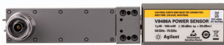
図3：V8486Aには、EEPROMが内蔵されていません。センサの背面に印刷されている校正係数をあらかじめパワー・メータに入力する必要があります。
