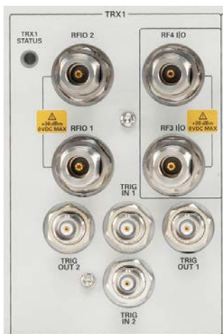
圖 8：EXM 的每個 TRX 都配有 4 埠 RFIO，包括兩個全雙工埠和兩個使用者可配置的半雙工埠。
