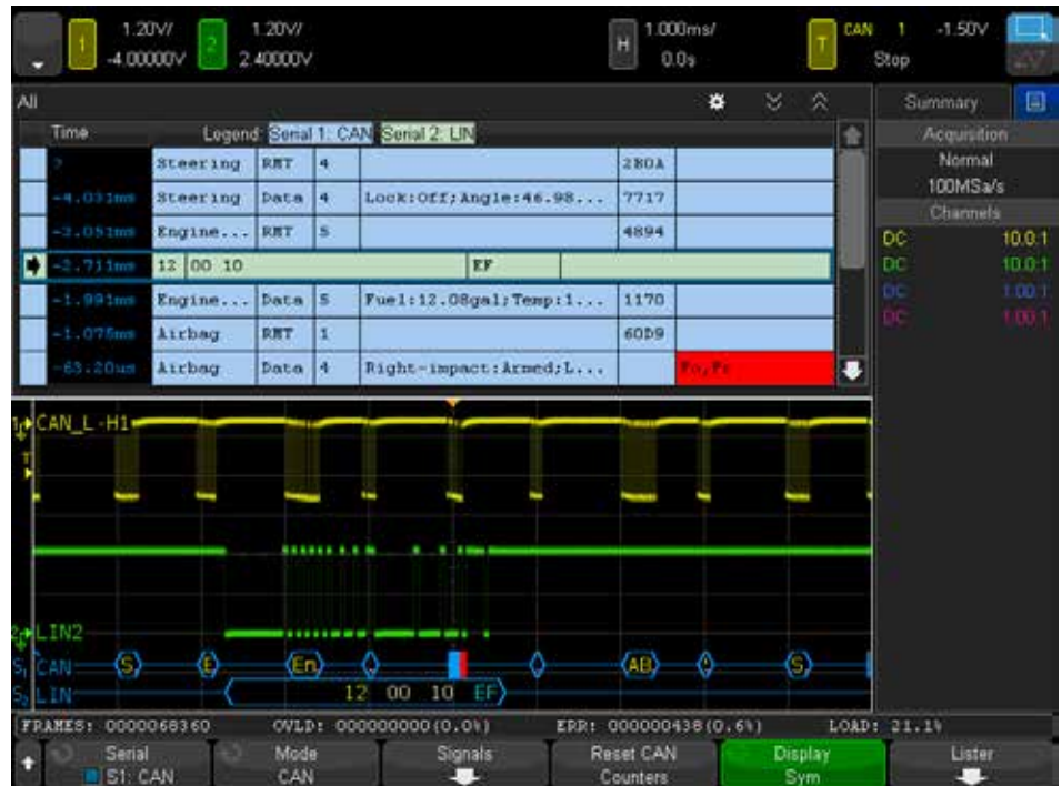
図1(a). Keysight InfiniiVision 4000 Xシリーズ オシロスコープを使った、LINバスとCANバスの同時のデコード
