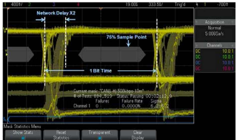
図5. Keysight InfiniiVision Xシリーズオシロスコープを使ったCANアイダイアグラム・マスク・テスト
