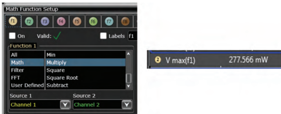
图6. 在通道1连接电流探头、通道2连接电压探头的情况下，可使用数学功能来计算瞬态功率或有效功率。Infiniium示波器支持单位变化，可以“W”（瓦特）为单位进行以上功率计算。
