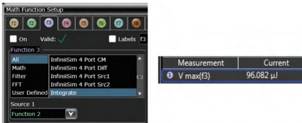
图7. Infiniium示波器提供16种独立的数学函数。如上所示，使用积分功能可计算特定功率波形下的总能量。
