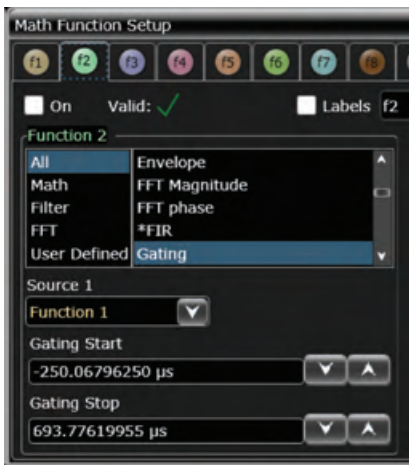
图 8. Infiniium S 系列可使用 16 种数学运算执行选通, 在选通区域或任意指定区域内实施测量。可对每个选通区域单独进行测量和分析。在上面示例中, 橙色波形上施加了选通 (或波形截取)。截取后的波形用另一和函数以绿色显示。
