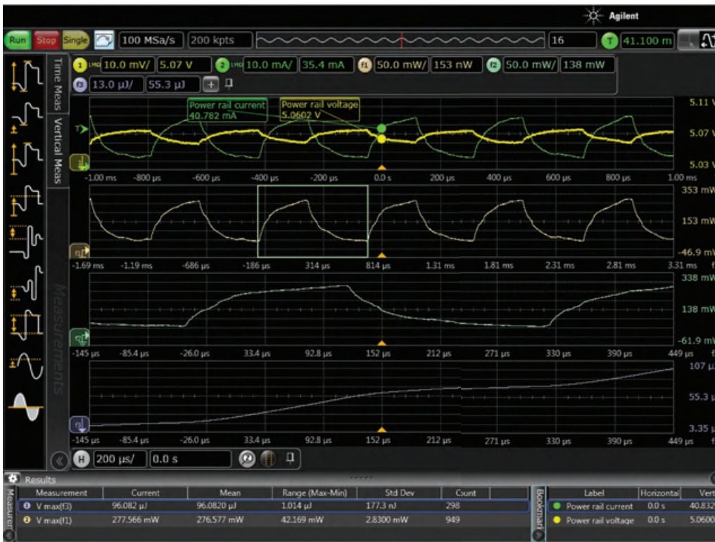
图 9. Agilent Infiniium S 系列提供运算、选通和测量功能, 可按照适当的单位值 (例如瓦特、焦耳和库伦) 报告低功耗测量结果。此图显示的是低功耗 USB 功率测量结果。通道 1 连接被测电源或电池以进行电压测量, 通道 2 提供对电源或电池的电流测量。您可以为指定选通区域单独设置功率、能量以及电荷测量结果。
